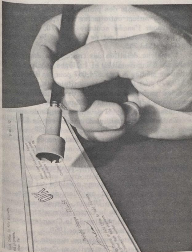
Le perma-timbre est conçu pour des marquages répétés et sert aussi à parafes des documents. Cet instrument très léger ressemble à un capuchon de crayon et s'adapte à l'extrémité d'un crayon ordinaire.
