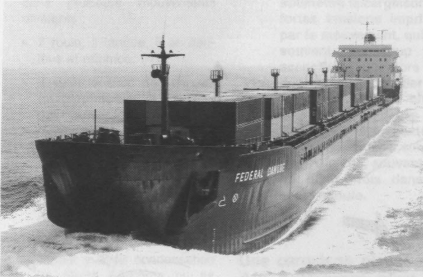
Vraquier des Grands Lacs et d'océan adapté au transport des conteneurs.
