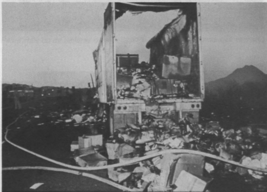
Explosion due à la friction de marchandises non arrimées.
