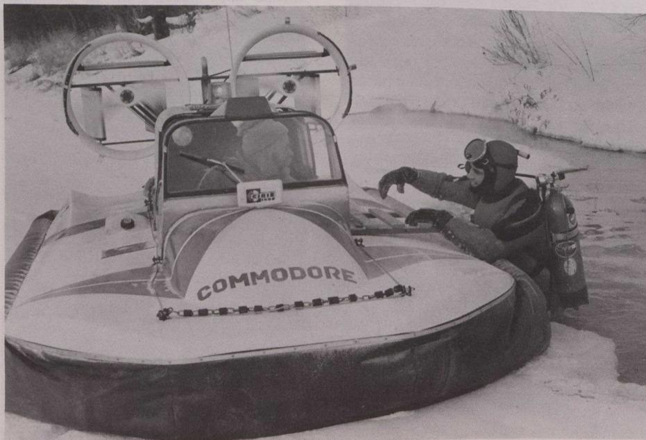
Un aéroglisseur Commodore est mis à l'essai dans les eaux glacées (-20°C) de la rivière Assiniboine (Manitoba). Il s'agit d'un véhicule conçu pour les opérations de sauvetage effectuées sur de grandes surfaces d'eau recouvertes d'une mince couche de glace ne permettant pas l'utilisation des méthodes habituelles.
