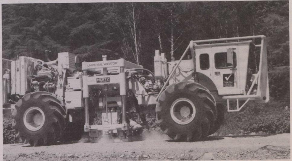
De lourds camions munis de vérins hydrauliques et dotés d'une plaque métallique possèdent un système à air comprimé qui fait vibrer la plaque et transmet des ondes de choc dans le sol.
