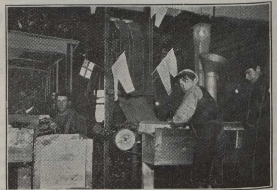
Ouvriers suédois arrangeant les allumettes avant qu'elles n'aillent aux mains des metteuses en boîtes
