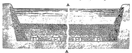
Fig. I.—Filtre de la compagnie Lambeth, de Londres—type ordinaire des filtres en Europe. (Pour reduire la figure, seules les deux extrémités du filtre sont representées, comme l'indique la cassure A A.)
