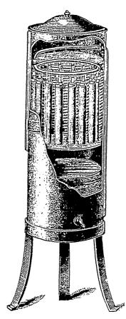
Fig. V.—Filtre Chamberland-Pasteur. Filtrede ménage sans pression. Dans le compartiment supérieur, les hougies reliées à un tube abducteur, plongent dans l'eau à filtrer. Le tube conduit l'eau filtrée dans le compartiment inferieur ou réservoir.
