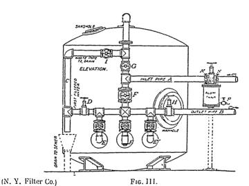
Ftg. 111.—Même filtre (parois en fer). On indique ici le réservoir d'alun (alun tank), greffe en M et N sur le tuyau d'arrivée de l'eau : Inlet pipe. Sand II de : trou à sable.
