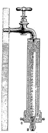
Fig. 1V.—Filtre Chamberland-Pasteur sous pression. L'eau entourant la bougie pénètre dans son intérieur A, et sort purifiée à l'extremite inferieure B
