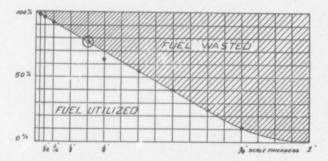
HOW IT WASTES FUEL-QUICKLY DROPS THE CURVE OF EFFICIENCY WITH EVEN SMALL SCALE CONTINGS QUICKLY THE BOLLER LOSES ITS POWER TO MAKE STEAM FROM BURNING COAL. THE POINT ON THE CURVE, MARKED BY THE LARGE CIRCLE, REPRESENTS THE AVERAGE THICKNESS OF SCALE AS REPORTED BY INSPECTORS OF FACTORY POWER PLANTS A LOSS OF 28 %
