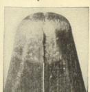
Autre Marque No 3— Conduit de l'encre ébréché, d'où interruption dans l'afflux d'encre. Usure irrégulière des bouts. Les côtés plats de la plume finissent en saillies sur la surface rugueuse d'écriture.
