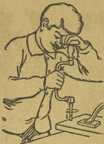
Manière de percer un trou vertical. On tourne le vilebrequin de la main droite en le prenant par l'olive; la main gauche appuie sur la pomme, la pression de la tête venant ajouter son action.
