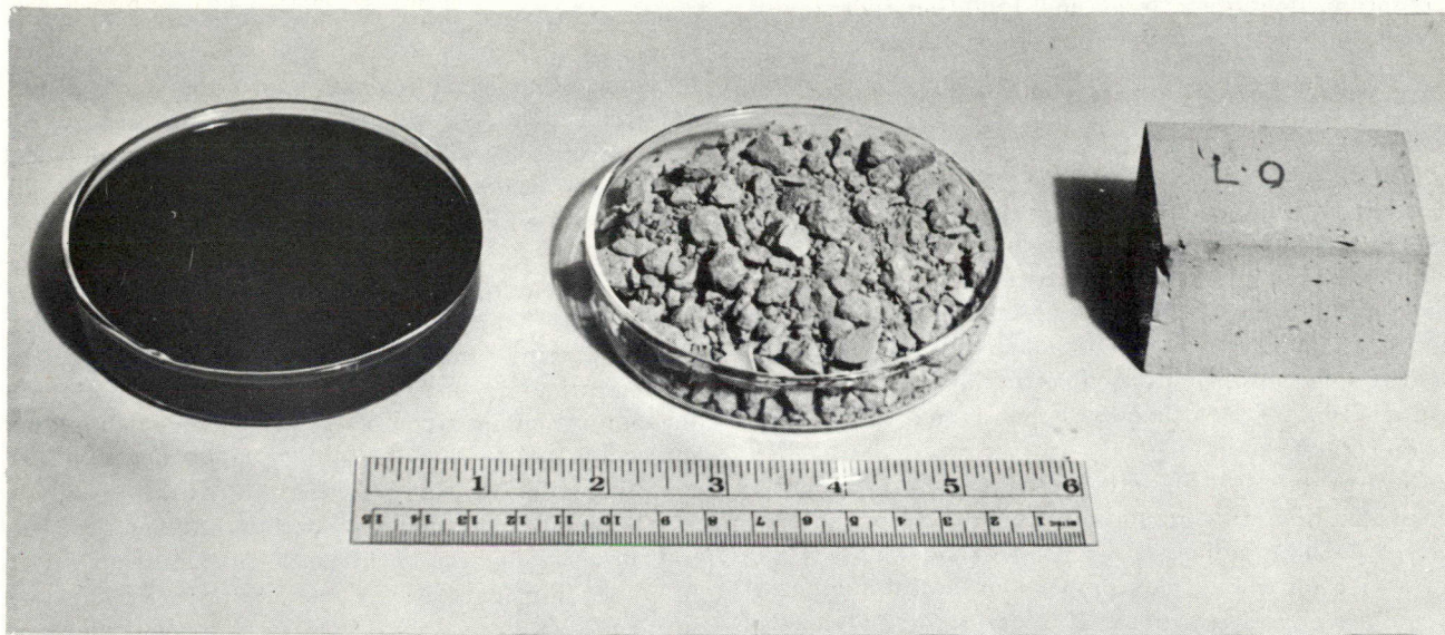
La liqueur résiduelle (à gauche) et l'argile ordinaire incorporant un agent moussant donnent la brique (à droite).
