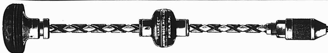
No 50, VILLEBREQUIN YANKEE , à billes, utilise des forets à tête de 3/16 de pouces ou moins de diamètre. Pas de mouvement perdu, le foret progresse continuellement sous l'action ascendante et descendante de l'ouvrier. Longueur totale, 18 pouces. Pour forer l'acier, le laiton et les autres métaux ainsi que le bois. L'outil le plus parfait fabriqué dans ce genre.
