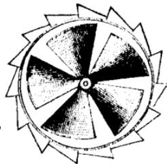
L'une des principales propriétés de ce ventilateur c'est qu'il est mis en mouvement, non seulement par le moindre vent, mais aussi par la différence de température de l'intérieur et de l'extérieur de la bâtisse.
