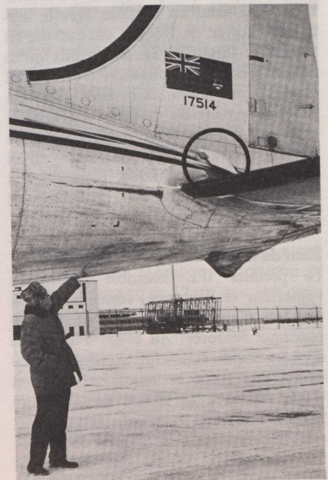
M. Harry Stevinson montre du doigt un IPE attaché au fuselage d'un avion des Forces canadiennes. Le bord d'attaque, maintenu à l'avion par un loquet à ressorts, se soulève lorsque l'IPE se détache, ce qui permet à l'air qui le frappe de le projeter loin de l'avion. Les avions très rapides sont munis d'un IPE encastré.
