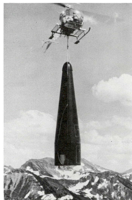
Les répéteurs sont protégés par des cloches en fibre de verre mesurant 8,5 mètres de haut. Certains de ces répéteurs ne sont accessibles que par hélicoptère (Photo: B.C. Hydro)
