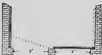
FIG. 1—Right angle sliding doors.
