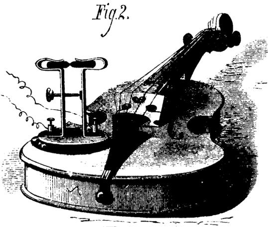
Fig. 2.—MICRO-TELEPHONE ON A VIOLIN.
