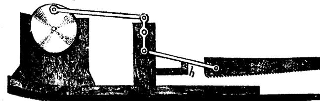
Fig. 2.—SHOWING CRANK AND LEVER ATTACHMENT.
