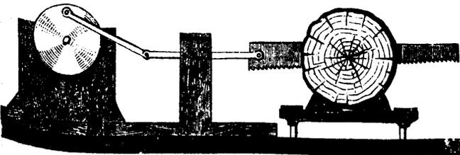
Fig. 1.—DRAG-SAW FITTED TO HORSE-POWER.
