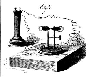
Fig. 3.-MICRO-TELEPHONE ON A PLAIN SOUNDING BOARD.
