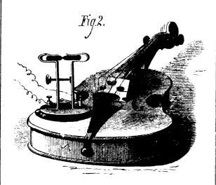
Fig. 2.-MICRO-TELEPHONE ON A VIOLIN.
