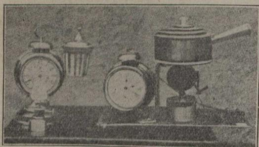
Le mécanisme de cet ingénieux appareil allume une lampe à alcool qui chauffe le contenu de la casserole.
