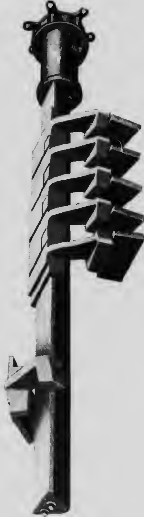
Four à griller mécanique Wedge. 1. Bras de rateaux. 2. Bras avec porte-lame de rateau et lames. 3. Bras monté partiellement avec porte-lame et casseur de blocs.
