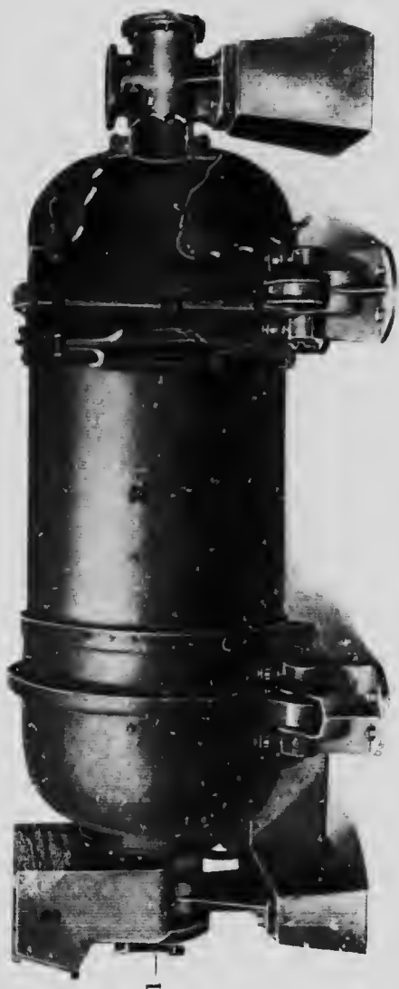
Four Stebbins rotatif pour brûler le soufre.
