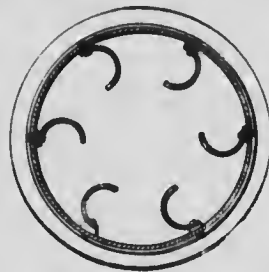
FIG. 29. Coupe transversale du brûleur Stebbins.
