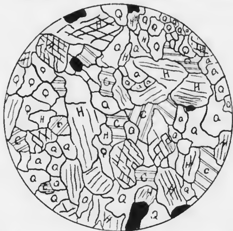
FIG. 5. Dessin à la chambre claire (pièce sur l'oculaire d'un microscope) d'une amphibolite gisant à la pointe Happy Outlook, Lac Opasatika. H, hornblende; Q, quartz; C, carbonate; taches noires, magnétites. Remarquer la distribution uniforme du carbonate.
