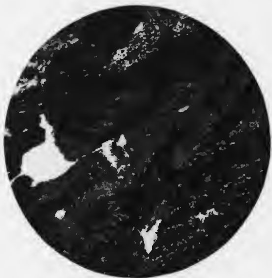
Photomicrographie montrant la structure eutaxitique du basalte dans le portage du Lac Dufresnoy au lac Sills. Lumière ordinaire. Grossissement 20 d.
