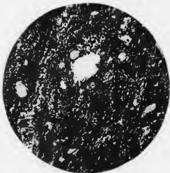
Photomicrographie de la matrice en grès du conglomérat de la série Pontiac, sur la rivière Kinojevis. Nicols croisés. Grossissement 20 diamètres. A remarquer la recristallisation partielle. Comparer avec la Planche XVI, le gruwacke originaire, et la planche XVIII, le produit final recristallisé.
