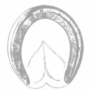
SHOE FOR CUTTING, SHOWING POSITION ON THE FOOT.
