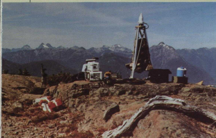
Station et antenne réceptrice du système de positionnement global (GPS), centrées sur un repère géodésique.
