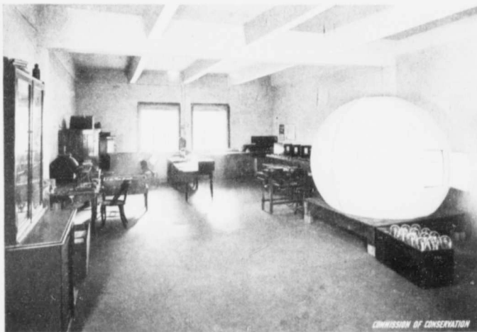
PORTION DU LABORATOIRE DES LAMPES DE LA ONTARIO HYDRO-ELECTRIC POWER COM- MISSION, TORONTO, ONT., GRAND PHOTOMETRE SUR LA DROITE
