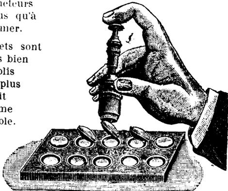
Le *Compresso-Doseur* devient Cacheur des *Capelliformes* en remplaçant son cylindre par celui du *Cacheteur*.
