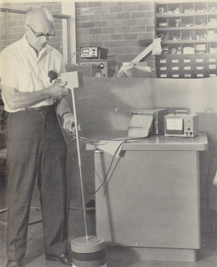
Edward Mills calibrates the conductivity probe developed during plasma research by the Gas Dynamics Section of NRC's Division of Mechanical Engineering. The probe is calibrated in fibre-glass discs containing copper-wire screens and having different electrical bulk conductivities. ● Edward Mills effectue l'étalonnage de la sonde mise au point par le Laboratoire de la dynamique des gaz du CNRC pour mesurer la conductivité. Pour ce faire, on emploie des disques de fibre de verre contenant des réseaux de fil de cuivre qui leur donnent des conductivités différentes.
