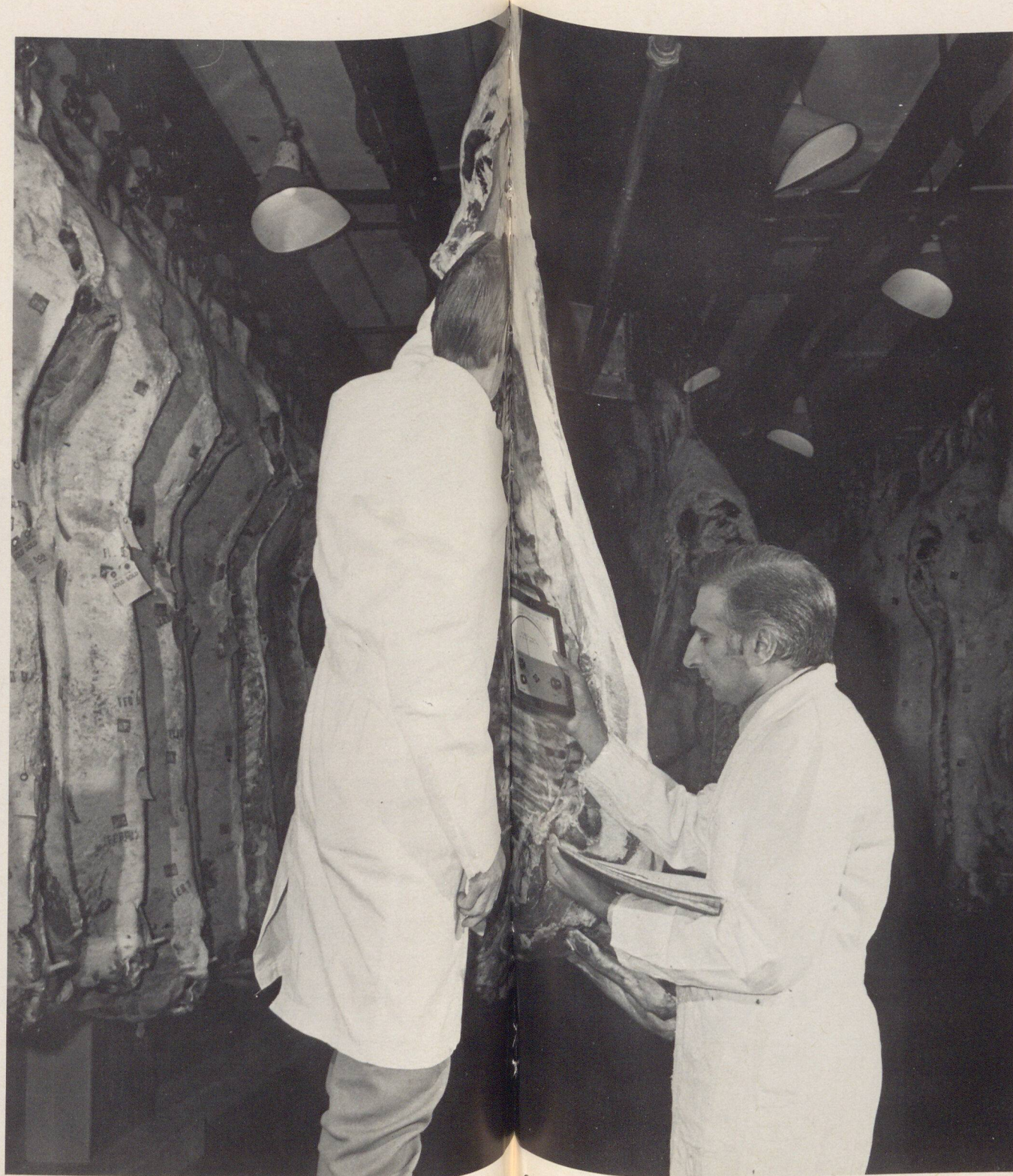
At Canada Packers' plant in Hull, Quebec, Dr. A.W. Khan (right) and G.W. Daechsel of NRC's Food Technology Section take pH measurements on exposed muscles of a carcass using a pH meter. ● A l'usine de Canada Packers, à Hull, dans la province de Québec, le Dr. A.W. Khan (à droite) et G.W. Daechsel, de la Section de technologie des produits alimentaires, font des mesures de pH à l'aide d'un pH-mètre.
