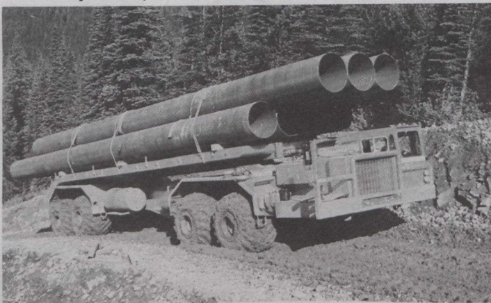
El Magnum, el mayor de los vehículos fabricados por Foremost, está equipado con neumáticos Terra y puede transportar hasta 64 toneladas en condiciones difíciles sobre todo tipo de terreno.
