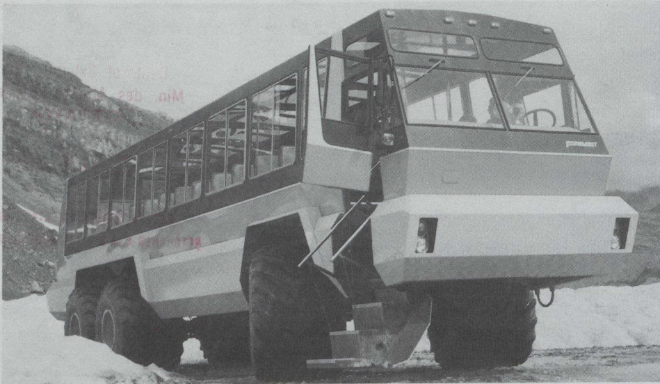
El Terra Bus permite transportar hasta 56 pasajeros por todo tipo de terrenos. Este autobús está equipado con los neumáticos de baja presión Terra, y puede utilizarse para el transporte de personal en todo terreno.
