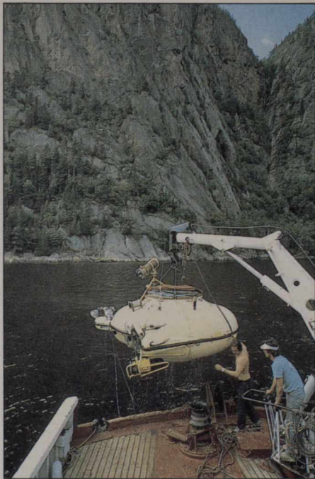
La soucoupe de plongée de la Calypso est mise à l'eau dans le Saguenay (Québec).
