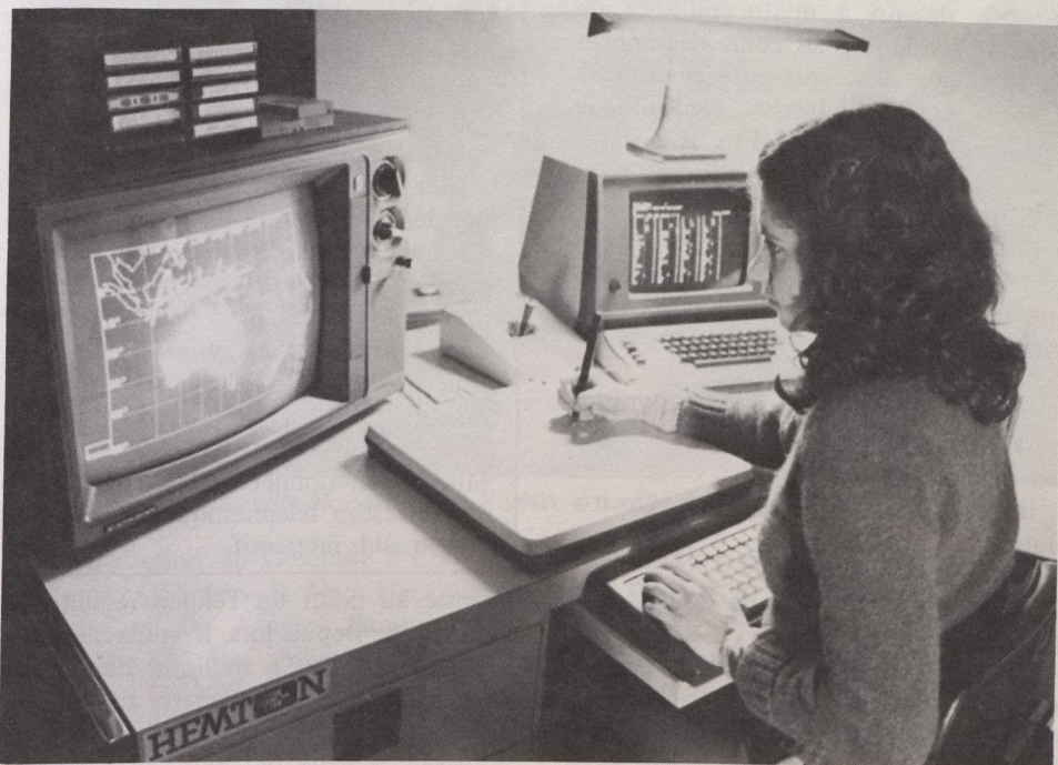
Télideon permet la réception ou la transmission de données. Combiné à l'appareil de télévision, un clavier à touches permet l'extraction ou l'introduction de renseignements.
