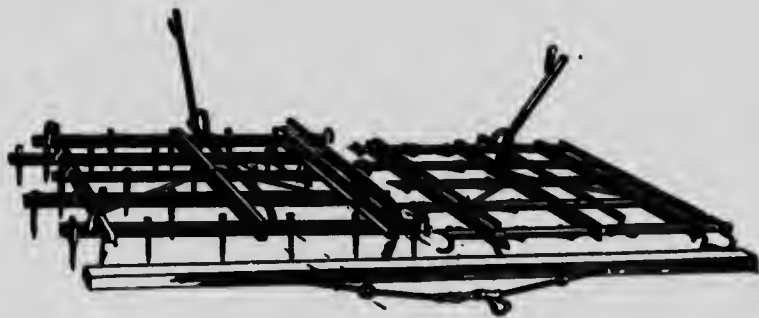
Herse à dents mobiles, très recommandable pour finir le travail d'ameublissement du sol.
