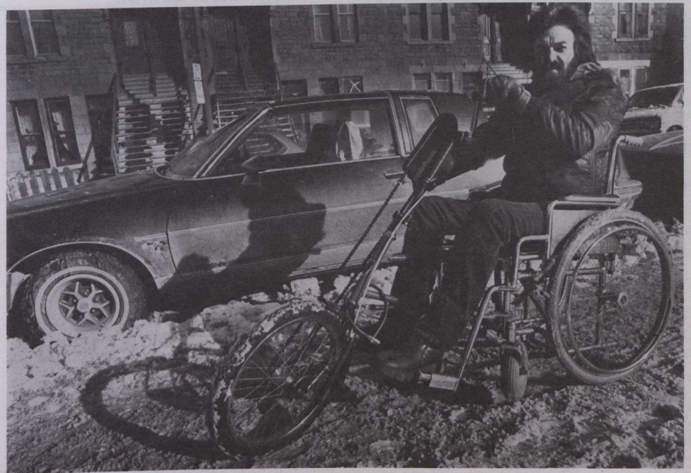
L'Unicycle est muni d'un frein et de trois vitesses. Le pneu de l'appareil peut être armé de crampons pour un meilleur déplacement sur la neige et la glace.
