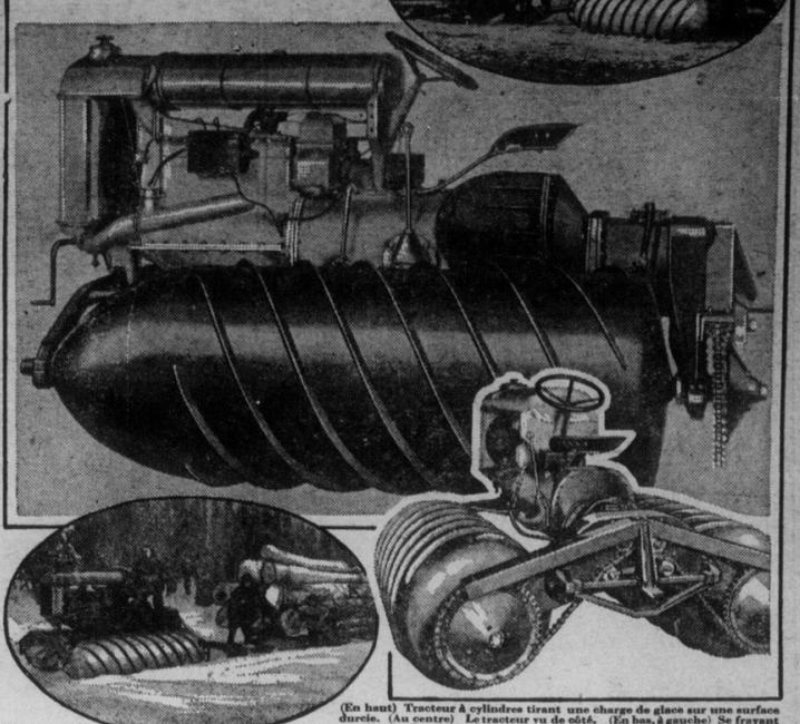
(En haut) Tracteur à cylindres tirant une charge de glace sur une surface durcie. (Au centre) Le tracteur vu de côté. (En bas à gauche) Se frayant un chemin dans six pieds de neige avec une lourde charge de bois. (A droite) Vue d'arrière du tracteur.
