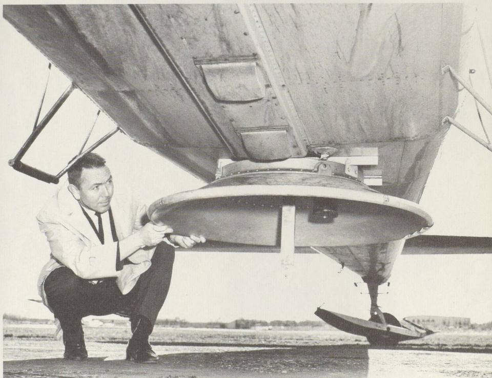
*Monsieur Ray Westby de la Division de génie électrique inspecte l'antenne du radar-altimètre qu'il a mis au point. Ce radar-altimètre émet un signal d'environ 4 200 MHz. Avec une très grande antenne on peut tout aussi bien employer des signaux de fréquence moindre, mais c'est bien du poids pour un avion léger . . .*
