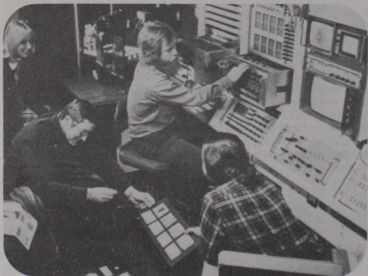
Técnicos de Image West, compañía en Los Angeles y filial de la Omnibus Corporation de Toronto, Ontario, preparan la computadora Scanimate para producir trabajo animado en una fracción del tiempo que tomaría en el empleo de métodos convencionales.
