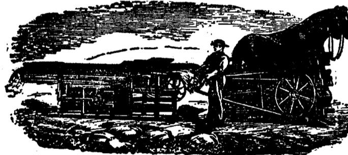
La machine à battre représentée dans la gravure plus haut est notre moulin Vibrateur. Cette machine a un silon de 28 pouces de long, les dents sont en acier garanti pour plier à froid sans se casser, tel que le norway.
