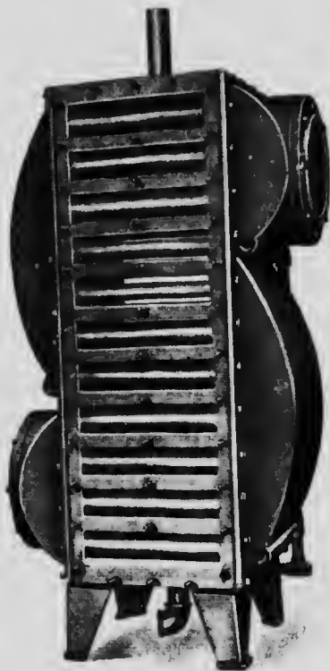
FIG. 8. — Réchauffeur Williams à courant d'eau transversal. Plaques de circulation arrière et avant enlevées, montrant les chambres à eau et leur facilité de nettoyage. Les sorties d'échappement s'ouvrent dans les plaques de circulation sur les côtés gauche et droit du réchauffeur et s'étendent latéralement jusqu'aux chambres à eau. Les parois des chambres à eau forment les parois des chambres à gaz d'échappement.
