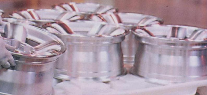
À partir d'aluminium de la Colombie-Britannique, l'usine produit des roues en alliage à l'aide de la technique de coulée basse pression.
