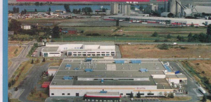
Établie sur un emplacement de 25 acres, l'usine de 19 000 mètres carrés située à Delta (C.-B.) produit des roues en alliage d'aluminium qui sont expédiées dans les installations de Toyota au Canada, aux États-Unis et au Japon.
