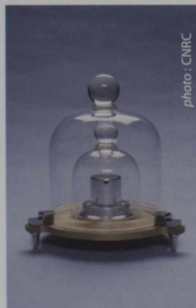
L'étalon canadien du kilogramme sous deux bocaux de verre au CNRC.
