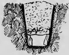
Fig. 1. Drain en pierres plates.
