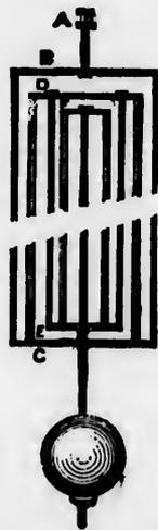
FIG. 27.—GRIDIRON PENDULUM.
