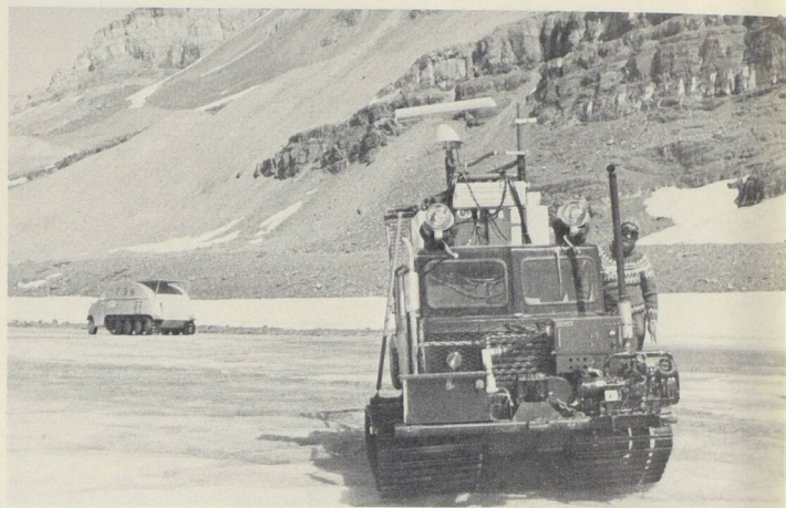
Radio echo sounding equipment under test on the Athabasca Glacier in Alberta. • Equipement de sondage par radio aux essais sur le glacier de l'Athabasca, dans l'Alberta.
