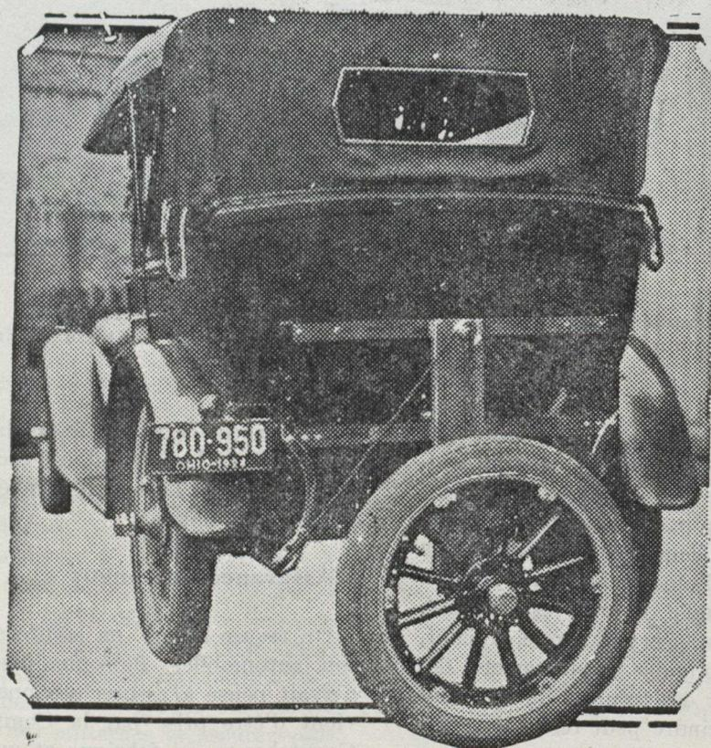
L'AUTO A CINQ ROUES. Grâce à l'invention de Ingemar K. Rystedt, ingénieur automobiliste de Dayton (Ohio) la roue de rechange que l'on porte à l'arrière peut servir à ranger la voiture pour la mettre en stationnement lorsque l'espace est exigü. La roue de rechange est abaissée, la voiture est mise en marche arrière et la roue conduit la voiture à sa place.
