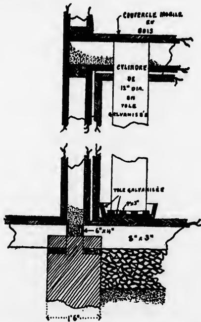
Fig. 4.—Coupe de la chambre froide montrant la disposition des cylindres.
