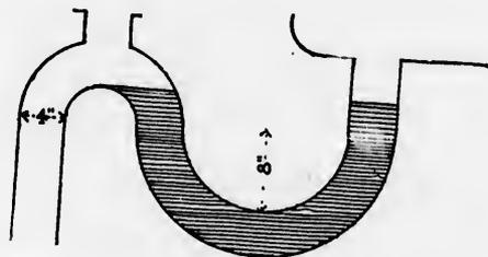
Fig. 6.—Joint hydraulique.
