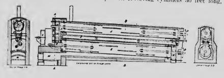
Fig. 164-The Simpson Drier.
