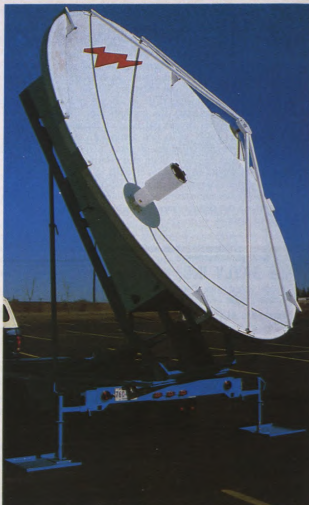
▲ Station terrienne transportable 4,5 mètres, 4/6 GHz de ANDREW ANTENNA.
