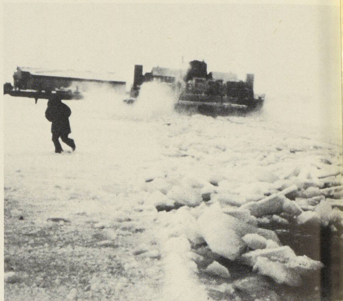
This large air cushion vehicle worked as an effective icebreaker during recent winter trials. Towed by a tractor, it broke a 70-foot-wide path through 27-inch thick ice, travelling at four miles per hour. • Essais récents en hiver d'une grande remorque à coussins d'air pour briser la glace. Elle est tirée par un tracteur à 4 miles à l'heure et brise une couche de glace de 27 pouces d'épaisseur sur 70 pieds de largeur.
