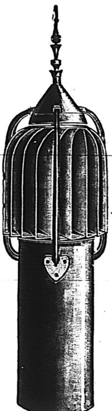
L'une des principales propriétés de ce ventilateur, c'est qu'il est mis en mouvement, non seulement par le moindre vent, mais aussi par la différence de température de l'intérieur et de l'extérieur de la bâtisse. L'hélice placée à l'intérieur de ce ventilateur non seulement établit un courant d'air continu, mais aspire ou pompe toutes les poussières, la fumée, les vapeurs, l'air vicié, etc.
