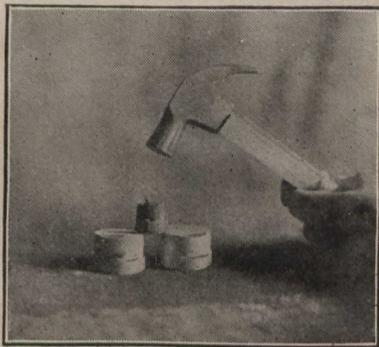
l'aiguille et le bouchon: Pan! ça y est. Remplaçant alors l'aiguille par un clou de la grosseur voulue, vous répétez l'opération, et vous aurez deux roues solides, qui ne vous coûteront que deux sous.
