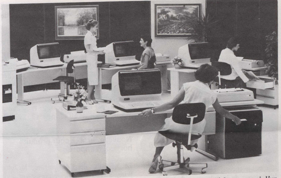
Cette version du C20 consiste en quatre postes de travail locaux (chacun muni d'un écran et d'un clavier électronique), cinq imprimantes atteignant chacune la vitesse de 540 mots/minute, une imprimante ligne par ligne dont la vitesse approche 8 000 mots/minute et une unité centrale (ou module central) renfermant le microprocesseur.
