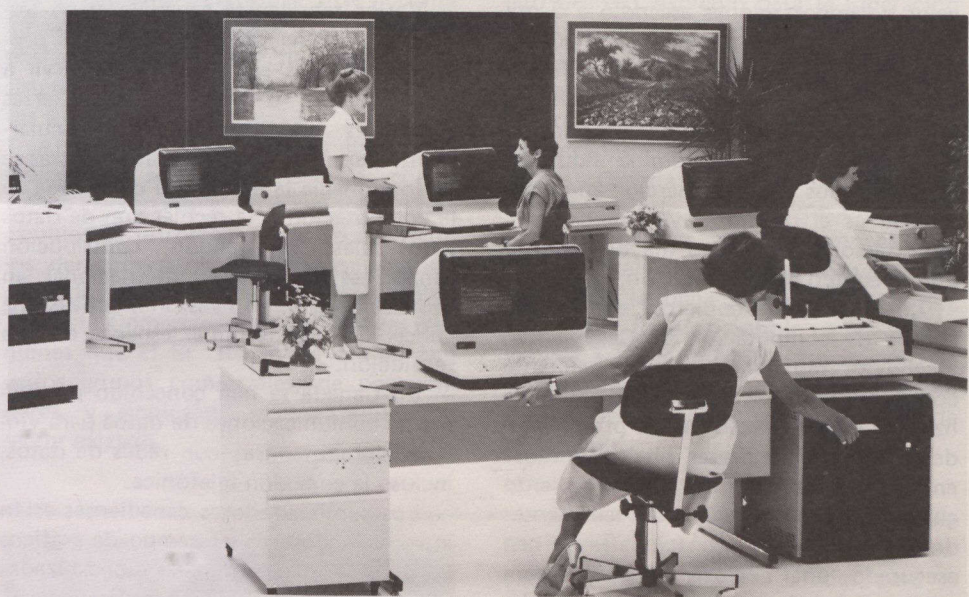
La versión AES C20 está compuesta de cuatro estaciones de trabajo conectadas a una central equipada con microprocesadora. Cada una de las cuatro unidades puede copiar hasta 540 palabras por minuto lo que hace que el sistema en conjunto pueda obtener hasta 8.000 palabras por minuto.
