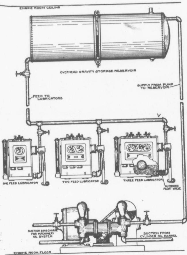
FIG. 2—DOUBLE-ACTING OIL PUMP
